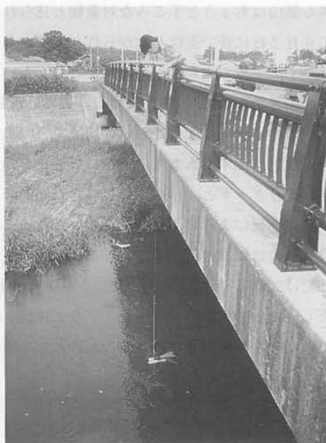
写真3 河川と水の調査・流速を計測中（薬師橋）
