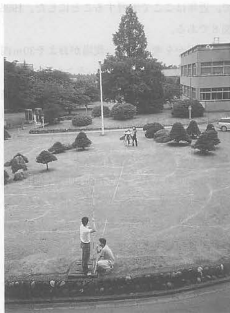
写真2 地形調査・平板測量
